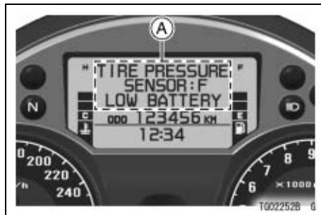
A. タイヤ空気圧センサバッテリー警告メッセージ(前輪側)
