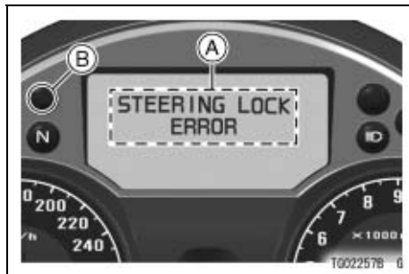
A. “STEERING LOCK ERROR” メッセージ B. 警告灯
