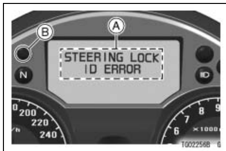
A. "STEERING LOCK ID ERROR" メッセージ B. 警告灯
